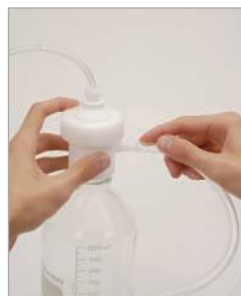
Connecter la ligne de vide sur l'embout latéral.
